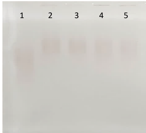
Gambar 89. Elektroforesis hasil reaksi konjugat antibody Mx1-nanopartikel emas dengan antigen Mx1 pada gel agarosa 0,3%. Reaksi dilakukan pada waktu yang berbeda. Keterangan: Lajur 1= konjugat Mx1-nanopartikel emas, lajur 2= reaksi konjugat Mx1-nanopartikel emas + antigen Mx1 tanpa inkubasi, lajur 3= reaksi konjugat Mx1-nanopartikel emas + antigen Mx1 inkubasi 15 menit, lajur 4= reaksi konjugat Mx1-nanopartikel emas + antigen Mx1 inkubasi 30 menit, dan lajur 5= reaksi konjugat Mx1-nanopartikel emas + antigen Mx1 inkubasi 45 menit
